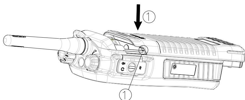
**Шаг 2** Откройте защелку аккумулятора и надавливайте на нее, пока металлический замок не втянется полностью в корпус аккумулятора, как показано ниже.
