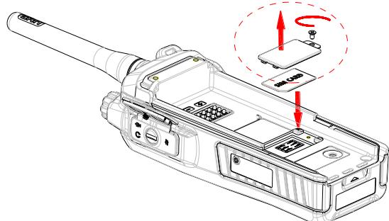
**Шаг 2** Верните крышку на место и затяните винт, как показано ниже.
